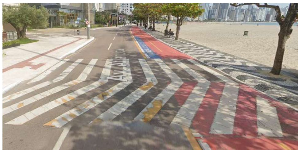
Figura 195 - Faixa Elevada de Travessia de Pedestres na interseção da Avenida Atlântica x Rua 4800 Fonte – Autor, 2025.
